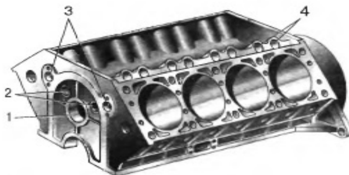
Рис. 24. Блок циліндрів двигуна класичної американської компоновки V8: 1-опори розподільного валу; 2-заглушки поздовжніх масляних каналів; 3-отвори системи охолодження; 4-отвори штовхачів.
