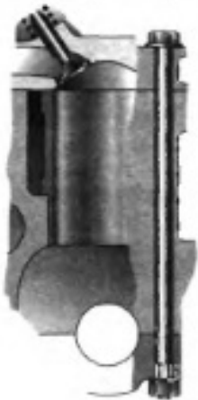
Рис. 22. Кріплення головки блоку анкерними болтами.
